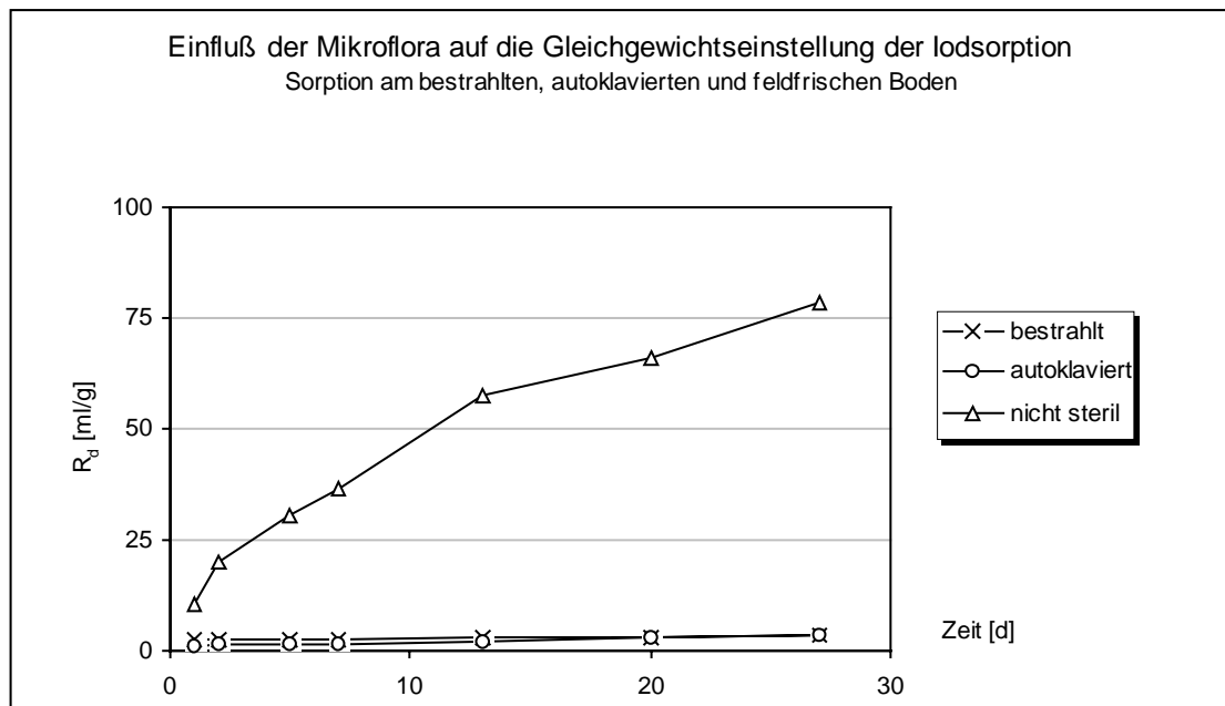
Abb. 3.4: Einfluß der Mikroflora auf die Gleichgewichtseinstellung der IodSORPTION, zeitlicher Verlauf der R_d -Werte an feldfrischem, autoklaviertem und bestrahltem Feinboden
